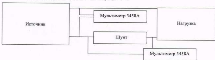
Рисунок 3 - Структурная схема определения абсолютной погрешности измерений/воспроизведений электрической мощности постоянного тока
